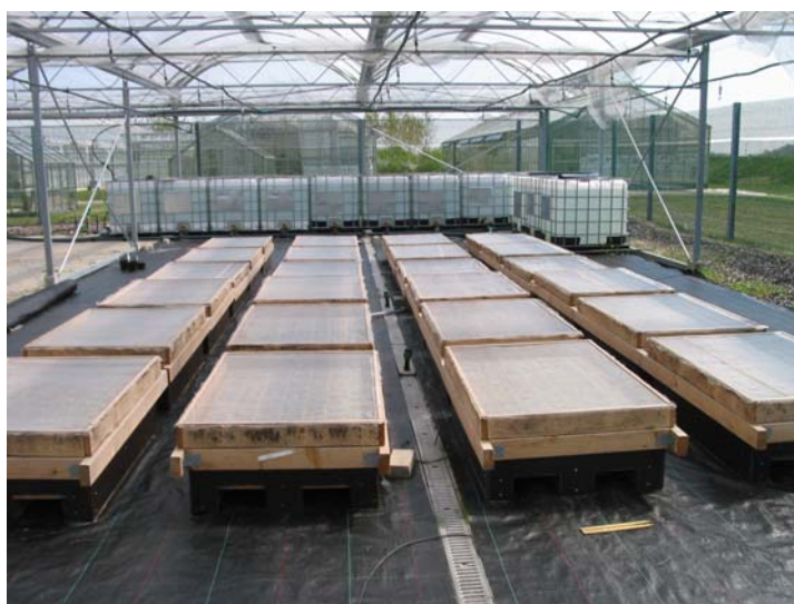
Figur 2. Belægningsforsøget (860/06) blev udført i beton- og naturstensbelægninger, lagt på specialfremstillede træpaller. For at undgå indflyvende ukrudtsfrø, er pallerne overdækket med et finmasket net. Pallerne er placeret i en overdækket voliere, hvor regnvand blev opsamlet i beholdere, og efterfølgende vandet ud med mikrosprinklere efter faste vandingsprogrammer.
