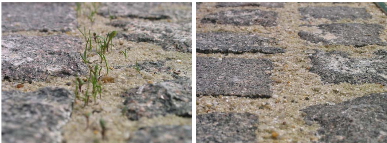
Figur 7. Belægningsforsøg 860/06: Enårig rapgræs og alm. brandbæger er generelt spiret godt i fugerne mellem naturstenene, men hvor der er anvendt 100% Danfugesand er intet fremspiret.
